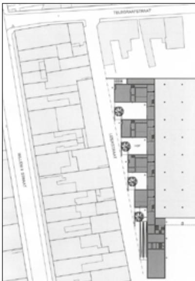
◀ Entlang der IJzerstraat wurde auf dem keilförmigen Grundstück eine kammförmige Gebäudestruktur mit vier Innenhöfen realisiert.
